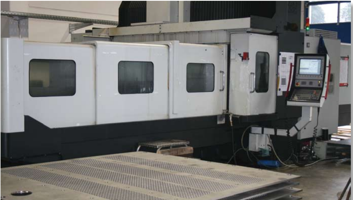
Bild 1: Produktion von Wärmetauscherplatten mit passgenauen Bohrungen auf einer Portalfräsmaschine Fabr. Kao Ming
