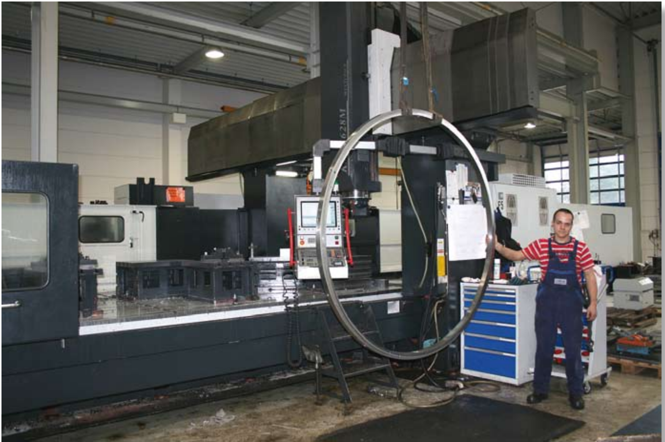
Bild 3: Auf der modernen Portalfräsmaschine Kao Ming wurden die Außen- und Innenkonturen von Edelstahlringen durch zirkulares Fräsen auf exakte Planparallelität gebracht
